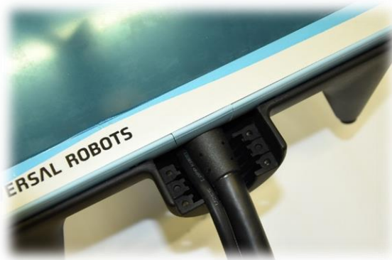
Abbildung 5: Leitungsverlegung am Klemmstück
