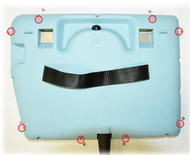
Abbildung 3: zu entfernenden Schrauben
