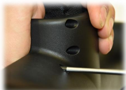
Abbildung 13: Verschrauben Case und Bedienpanel
