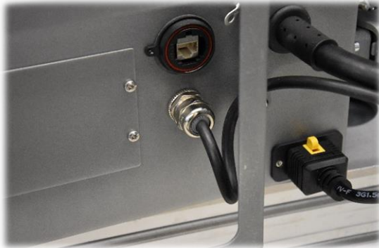
Abbildung 17: Durchführung für den Medienschlauch
