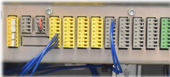
Abbildung 20: Verdrahtung Klemmleiste und Klemmen UR Controller
